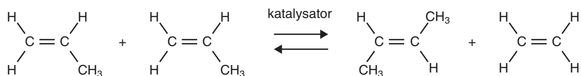
Figur 1. Två molekyler propen undergår olefin-metates med hjälp av en katalysator och ger som produkter de två nya alkena buten och eten.
